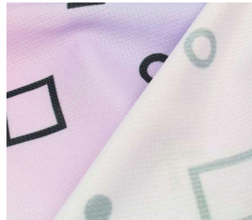
ТРИКОТАЖНОЕ ПОЛОТНО (ЛОЖНАЯ СЕТКА 135 ГР./КВ.М.)
