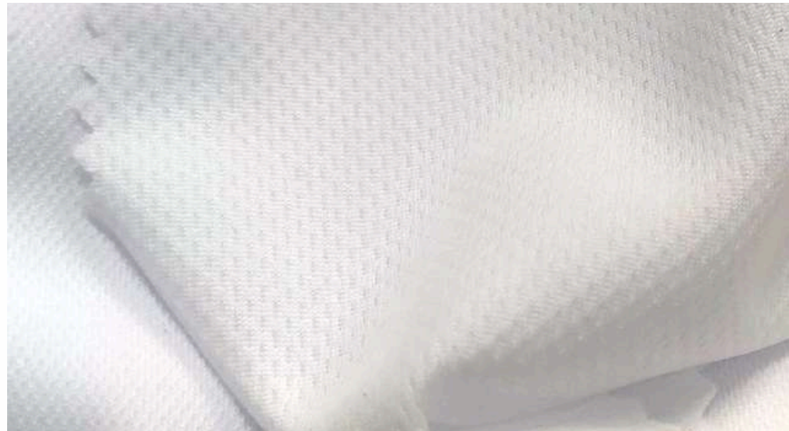
Трикотажное полотно (Ложная сетка 135 гр./кв.м.)
