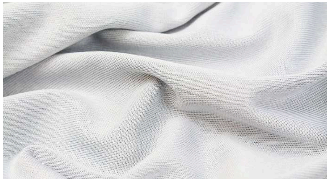
Трикотажное полотно (Прима микрофибра 135 гр./кв.м.)
