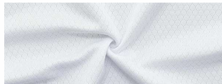
Трикотажное полотно (Баклава Эксклюзив 140 гр./кв.м)
