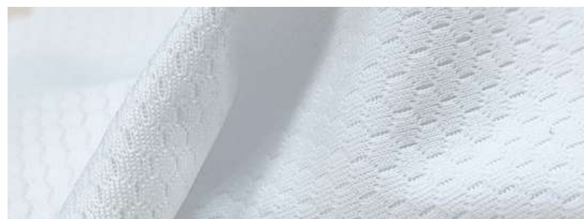
Трикотажное полотно (Сота кулпасс 160гр./кв.м.)
