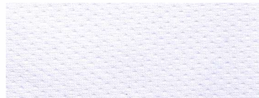
Трикотажное полотно (Ника 135 гр./кв.м.)
