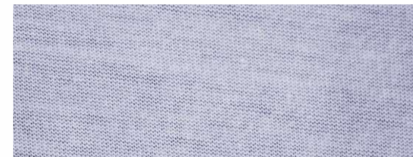
Трикотажное полотно (Джерси 145 гр./кв.м.)
