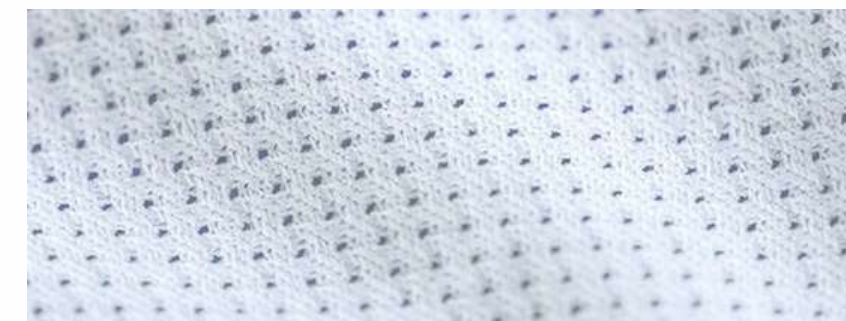
Трикотажное полотно (Сетка Олимп 120 гр./кв.м.)
