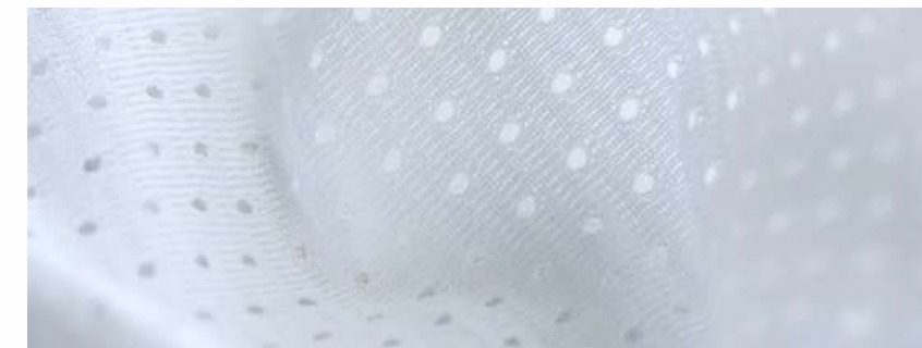
Трикотажное полотно (Хоккейная сетка 120 гр./кв.м.)
